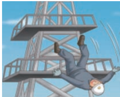
타워크레인 마스트 연장 작업 중 작업 발판에서 떨어짐
