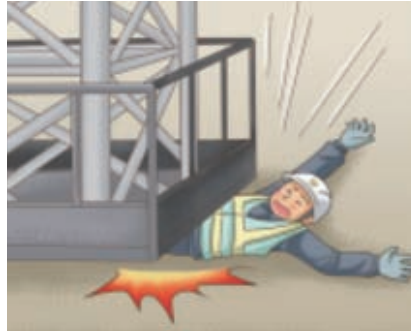
타워크레인 마스트 연장 작업 중 작업 발판에 끼임
