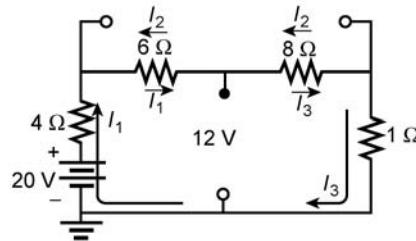
$$20 \text{ V} - 4I_1 - 6(I_1 - I_2) - 8(I_3 - I_2) - 1I_3 = 0$$
