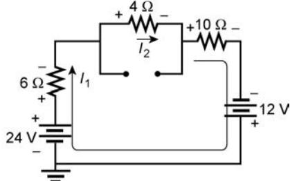
$$24 \text{ V} - 6I_1 - 4I_2 - 10I_1 + 12 \text{ V} = 0$$
